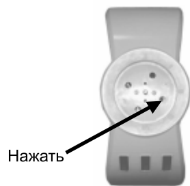
Рис.2. Расположение штока на термовыключателе термостата
