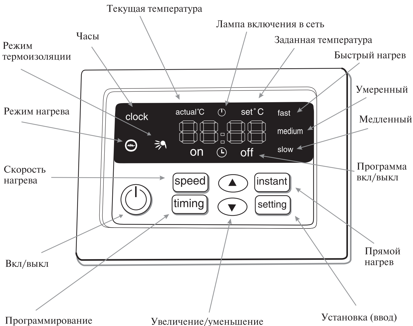
Рис.1. Расположение функциональных кнопок блока управления.
